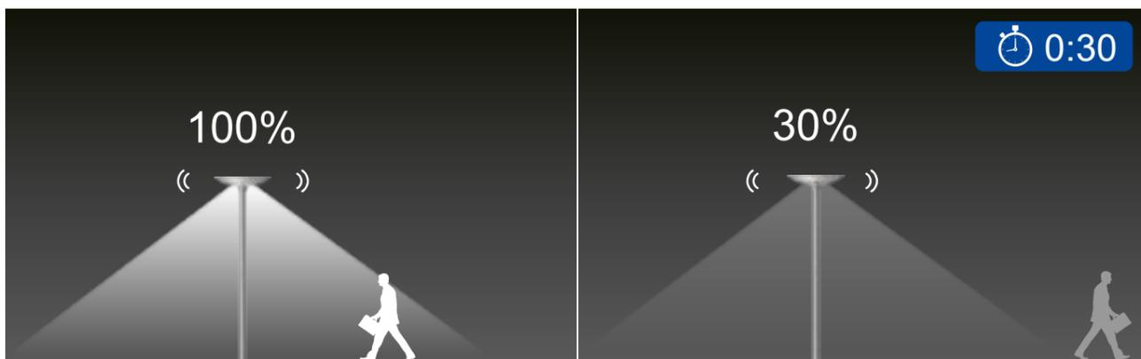
Lors d'une détection le luminaire augmente sa puissance jusque 60% et redescend à 20% après 30 secondes.
